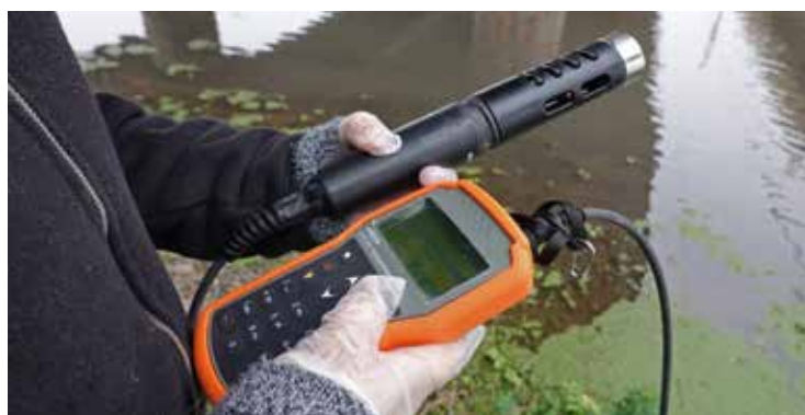
Figura 3. Medición de parámetros físico-químicos por medio de una sonda multiparámetro. Fotos: Proyecto GEF Humedales Costeros
