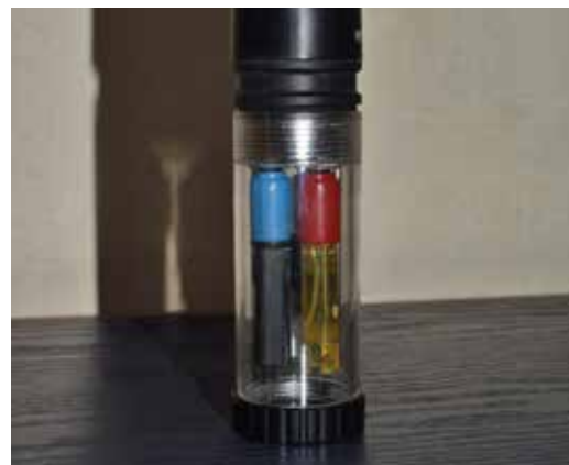
Figura 10. Preparación de la sonda para calibración de Porcentaje de Saturación de Oxígeno
