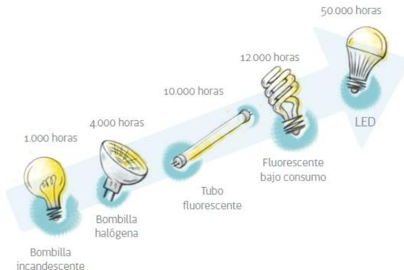
**Figura 1** - Comparación de la durabilidad de ampolletas (Fuente: MMA, 2016).
