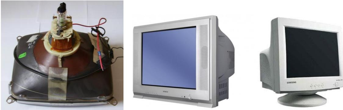
**Figura 3** (izq.) -Tubo de rayos catódicos(CTR) que procesa las señales eléctricas en un monitor (Fuente: CC BY-SA 3.0, <https://commons.wikimedia.org/w/index.php?curid=172650>). **Figura 4** (centro) – Televisor de CTR (Fuente: <http://www.ohmygeek.net/2015/12/22/televisores-crt-plasma-led-oled-lcd/>). **Figura 5** – Monitor de computador de CTR (Fuente: <http://www.maestrosdelweb.com/conoce-la-historia-de-los-monitores/>)
