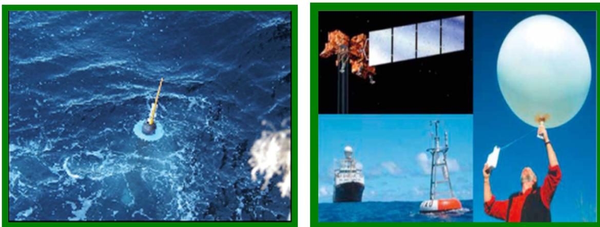
Figura 3. Boyas derivantes. Figura 4. Instrumentos de monitoreo aéreo, marítimo y satelital
